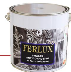
In un unico prodotto sono stati riunite le caratteristiche di uno smalto di ottima qualità e di una resistente antiruggine. Costituito da un veicolo acril-poliuretano ad alta resistenza agli agenti atmosferici e da un pigmento micaceo di elevato potere anticorrosivo.
